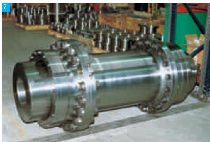
8 Acoplamiento de dientes de gran tamaño (diámetro exterior > Ø 1800 mm) para convertidor en Acería.
